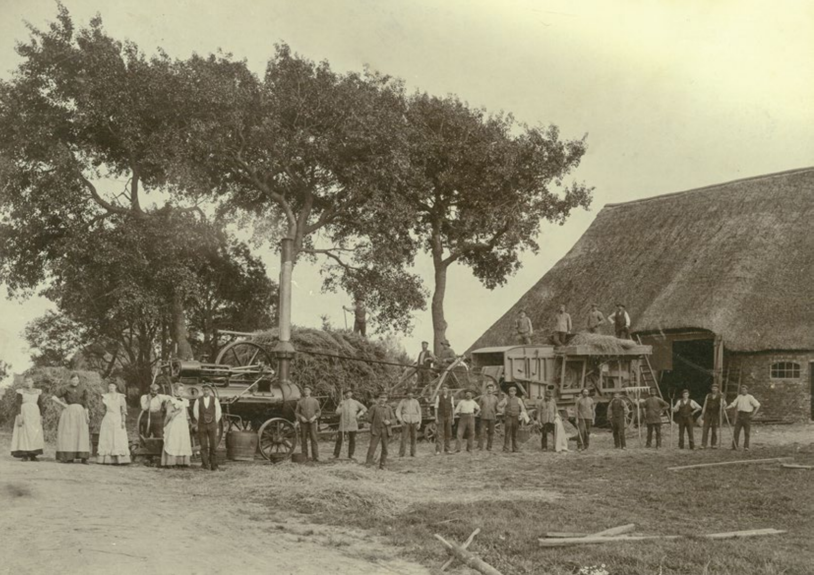
Eine Lokomobile dient einer Dreschmaschine als Antrieb.
